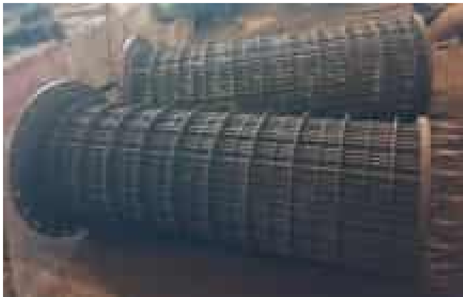
Figura 4. Intercambiador desarmado donde se observan los deflectores del lado del aceite
