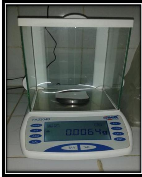
**Figura 3. Imagen de la balanza analítica utilizada para determinar la masa de las larvas de *C. montrouzieri*.**
