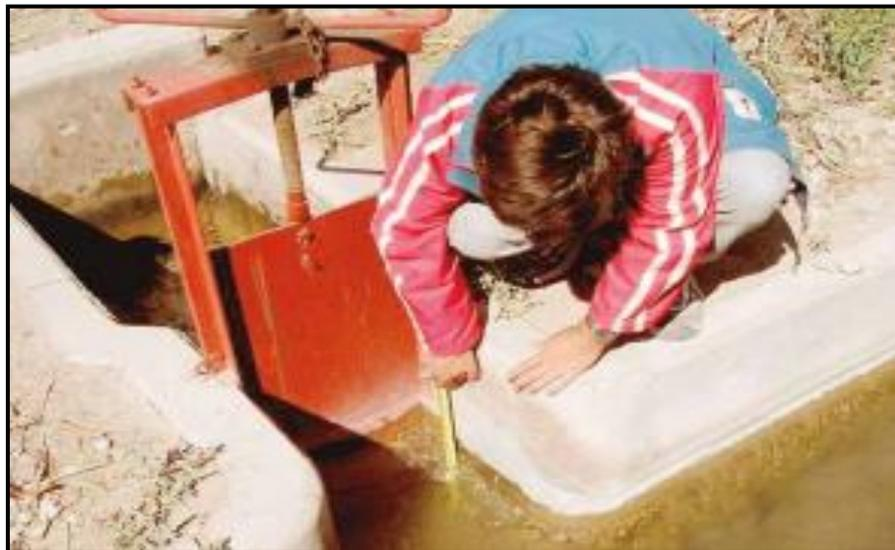
**Figura 1.13** Medición del caudal en una compuerta.
