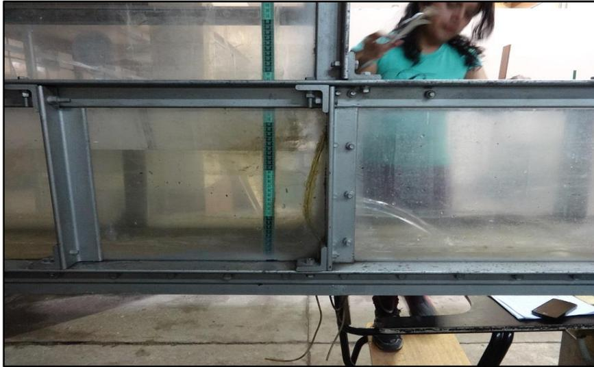
**Figura 2.4** Medición de las lecturas  $H$  a una distancia  $d$  del dispositivo.
