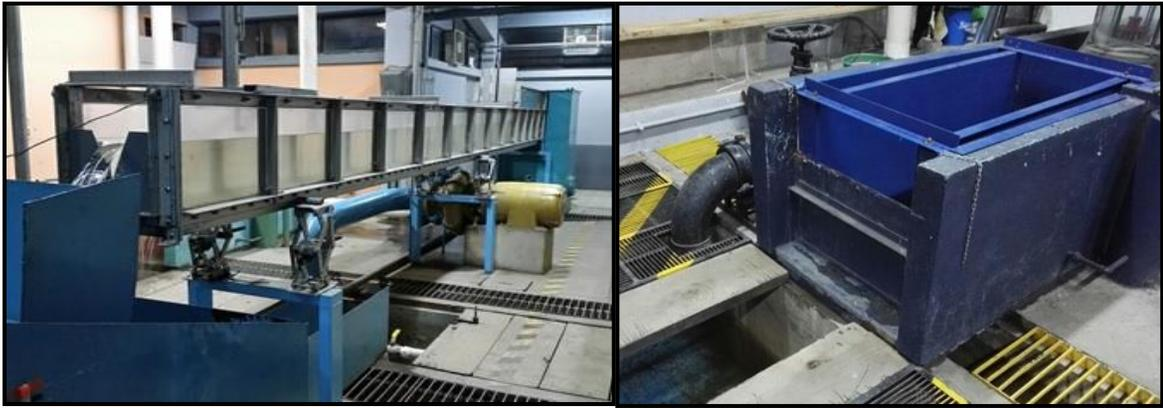
**Figura 2.1** Canal de pendiente variable y canal de pendiente fija.
