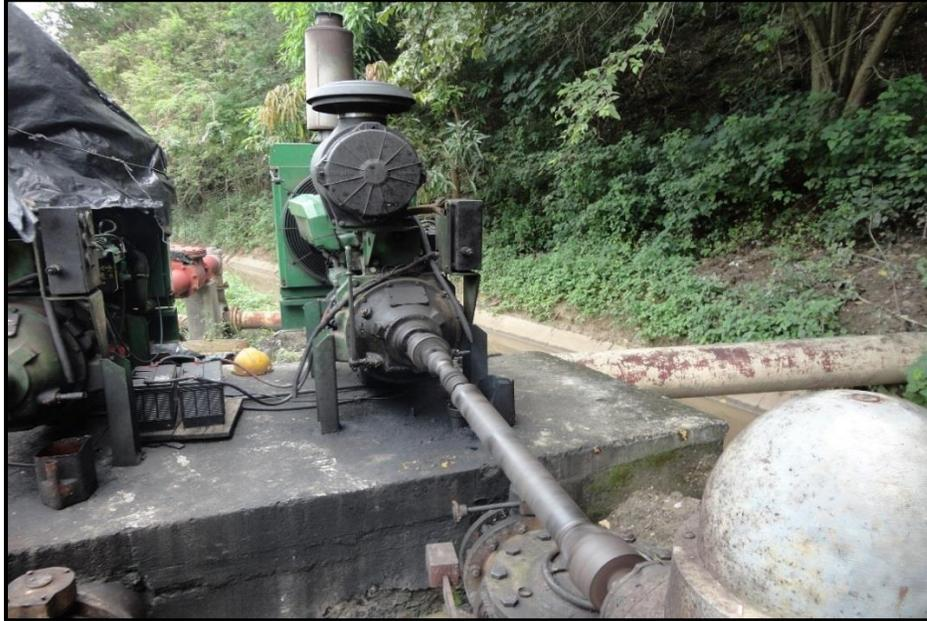
**Figura 3.19** Derivación del agua en el canal de riego mediante bombeo.
