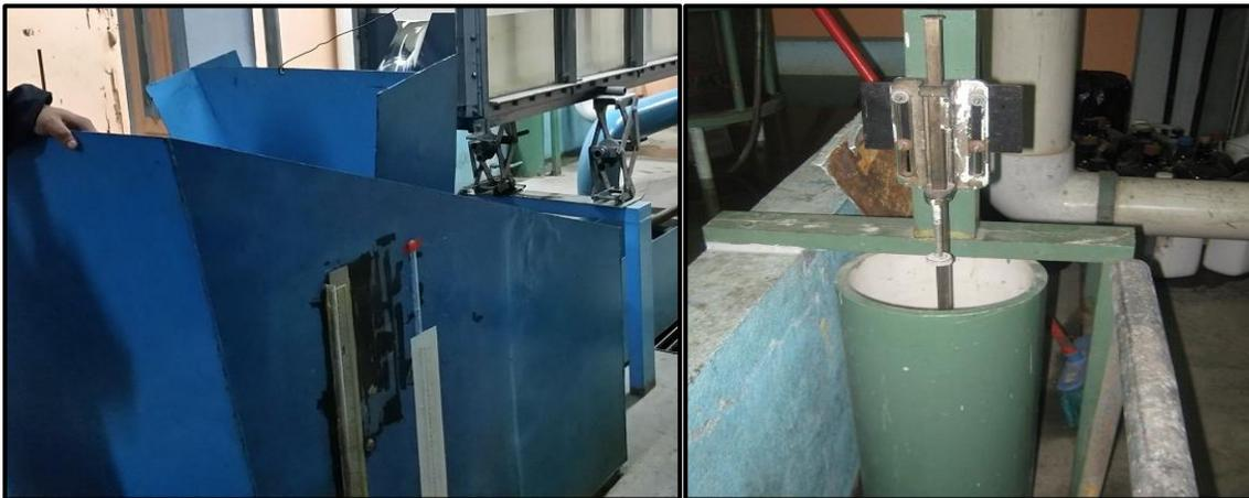
**Figura 2.3** Tanque de aforo y tanque de estabilización.
