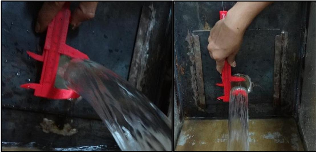
**Figura 2.17** Medición del diámetro contraído con el Pie de Rey.
