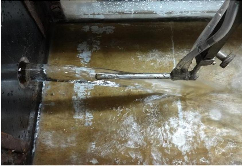
**Figura 2.18** Medición de la velocidad experimental con el Tubo de Prandtl.
