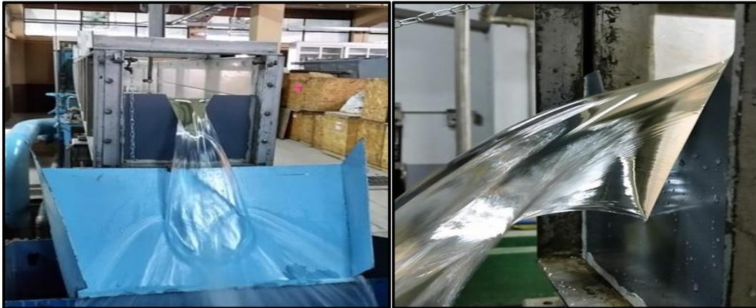
**Figura 2.6** Pruebas en los vertedores triangulares.
